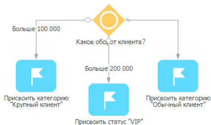
Рис. 58 — Пример использования логического оператора [Включающее “ИЛИ”] для ветвления
