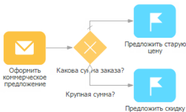
Рис. 56 — Пример использования логического оператора [Исключающее "ИЛИ"] для ветвления
